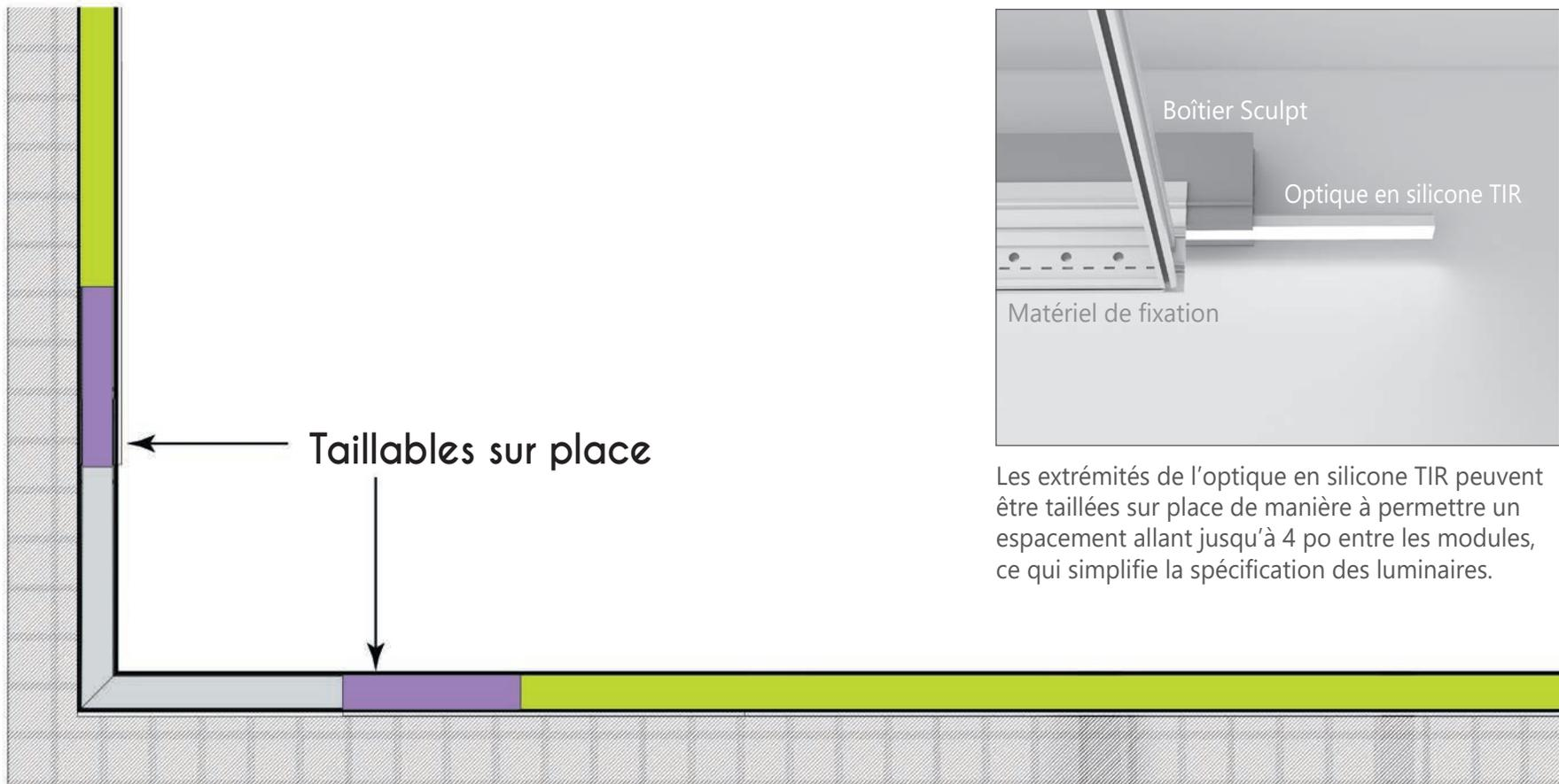
Les extrémités de l'optique en silicone TIR peuvent être taillées sur place de manière à permettre un espacement allant jusqu'à 4 po entre les modules, ce qui simplifie la spécification des luminaires.
