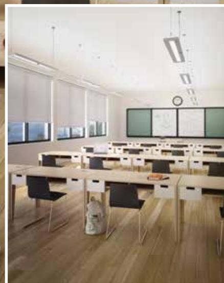
Avec 7 luminaires par rangée, cette même configuration en damier produira 41 fc et une densité de puissance lumineuse de 0,51 W / pi<sup>2</sup>.
