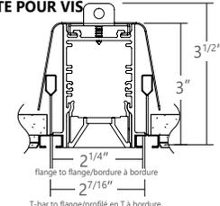
**ST** SCREW SLOT T-BAR
