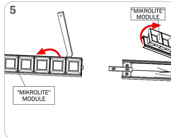
**ENFILEDE CONTINUE:** SUIVRE LES ÉTAPES 1 À 3 POUR INSTALLER LE PROCHAIN LUMINAIRE DANS LE PLAFOND, RETIRER LES VIS DES CARTES DEL AUX EXTRÉMITÉS ET SUR LE SUPPORT DE RACCORD
