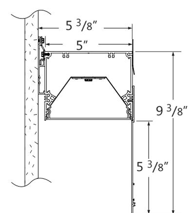
La version Perimeter est offerte dans différentes hauteurs en retrait, selon un rapport espacement-hauteur allant jusqu'à 1:1. Ces luminaires à éclairage périphérique sont fixés sur un rail mural permettant une installation rapide et uniforme. Ils sont compatibles avec différents systèmes de faux plafonds ainsi que les plafonds en gypse.
