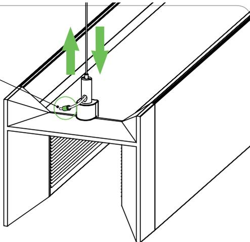
PRESS ON GRIP LOCK AND MOVE FIXTURE UP AND DOWN TO ADJUST THE HIGHT
