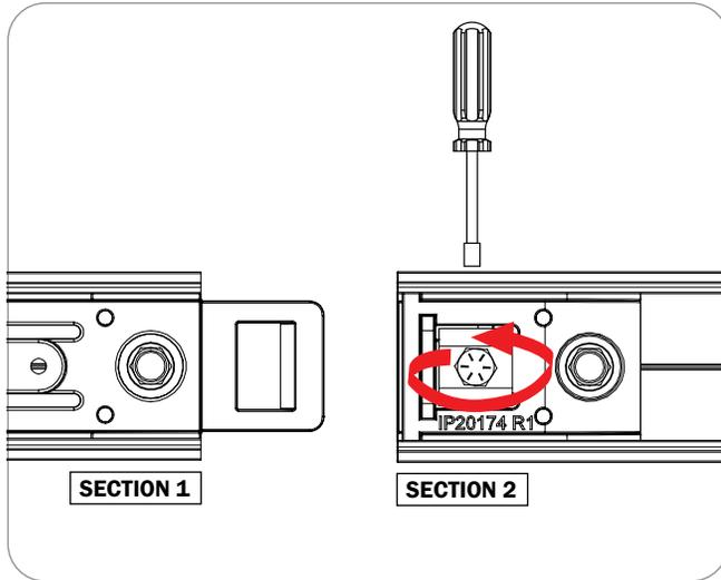
**LOOSEN SCREW BEFORE JOINING**
