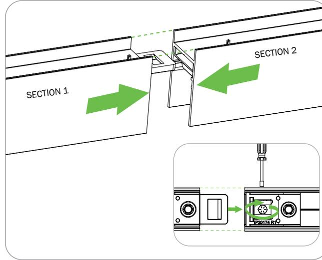
**JOIN EXTRUSIONS AND TIGHTEN SCREW**
