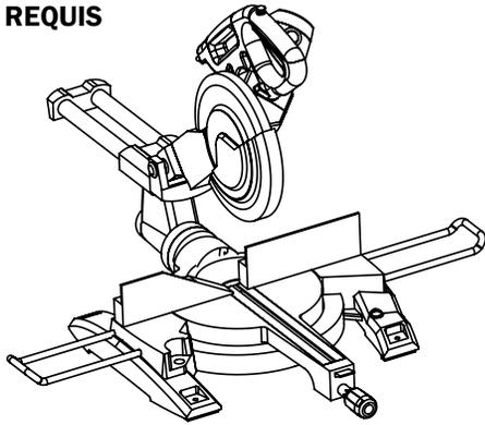
MITER SAW WITH ALUMINUM CUTTING BLADE
