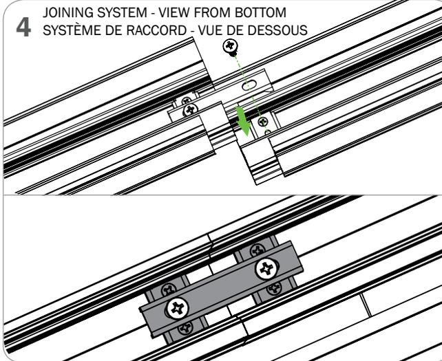
JOINING SYSTEM - VIEW FROM BOTTOM
