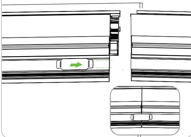
**CONTINUOUS RUN:** INSTALL ALIGNER INTO THE FIRST EXTRUSION.
