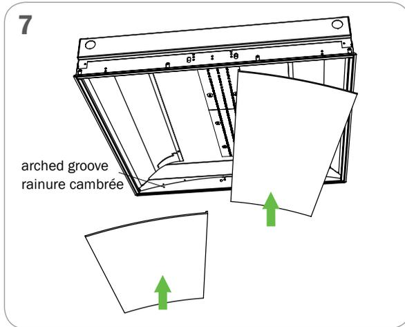
MAKE SURE NEW LENSES ARE SEATED ON THE ARCHED GROOVE INSIDE THE HOUSING.
