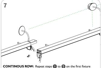
Apply steps 1 to 4 on the following fixture. ENFILADE CONTINUE: Répéter les étapes 1 à 5 sur le premier luminaire de l'enfilade.
