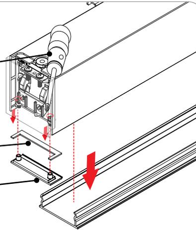
REMOVE BOTTOM PLATE (COME WITH GASKET) AND LENS.
