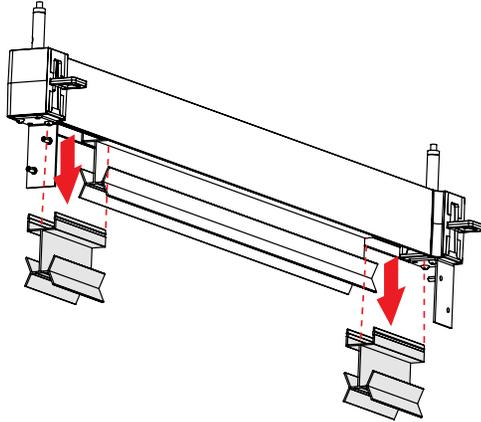
REMOVE SIDE EXTRUSION PIECES FROM ALL OF THE SEGMENTS FOR JOINER ACCESS
