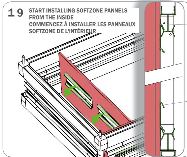
19 START INSTALLING SOFTZONE PANNELS FROM THE INSIDE
