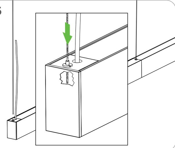
THE JUNCTION BOX MUST BE SOLIDLY FIXED AND ATTACHED TO THE STRUCTURAL MEMBER INSIDE TO THE CEILING CONNECT THE POWER CORD TO THE CEILING POWER FEED
