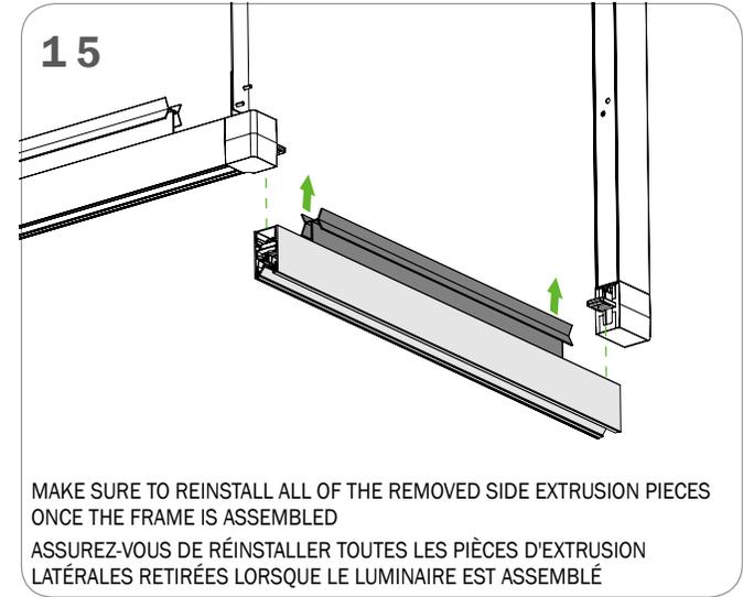
MAKE SURE TO REINSTALL ALL OF THE REMOVED SIDE EXTRUSION PIECES ONCE THE FRAME IS ASSEMBLED
