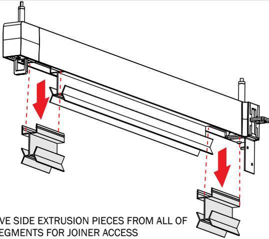
REMOVE SIDE EXTRUSION PIECES FROM ALL OF THE SEGMENTS FOR JOINER ACCESS
